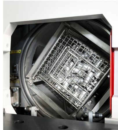
Effet de nettoyage ciblé par oscillation et rotation du support
